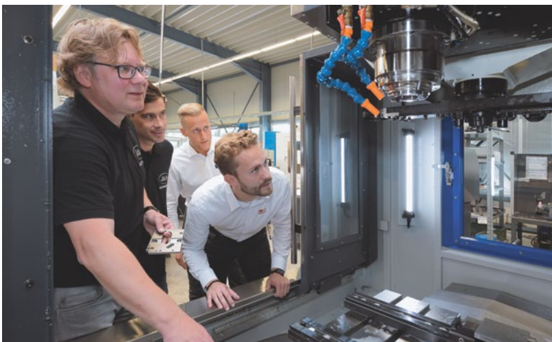
Das Werkzeugwechslerupgrade und die optimierte Kühlung durch die Spindel findet guten Anklang
